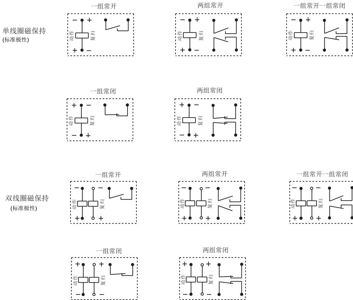
备注：以上为标准极性产品的接线图说明，反极性产品的线圈极性应与相应的标准极性产品相反。
