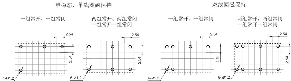
备注: (1) 产品部分外形尺寸未注尺寸公差, 当外形尺寸 $\leq 1\text{mm}$ , 公差为 $\pm 0.2\text{mm}$ ; 当外形尺寸在 $(1 \sim 5)\text{mm}$ 之间时, 公差为 $\pm 0.3\text{mm}$ ; 当外形尺寸 $>5\text{mm}$ , 公差为 $\pm 0.4\text{mm}$ ;
